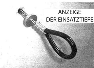
**QUICKLOCK muss einwandfrei positioniert werden. Achten Sie darauf, dass die Anzeige der Einsatztiefe (1) zur Hälfte in das Bohrloch eingeführt ist. Die Kabel der Halbmuscheln müssen symmetrisch stehen (siehe Foto). Überprüfen Sie die Festigkeit der Arretierung, indem Sie leicht an der QUICKLOCK-Schleife ziehen.**
