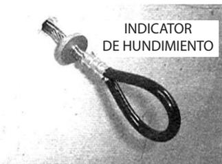
**Coloque el QUICKLOCK en la posición correcta. Procure que el indicador de hundimiento (1) se encuentre introducido hasta la mitad en el orificio. Los cables de las 1/2 conchas deben estar simétricos (ver fotos). Compruebe la firmeza del bloqueo realizando una ligera tracción sobre la hebilla del QUICKLOCK**
